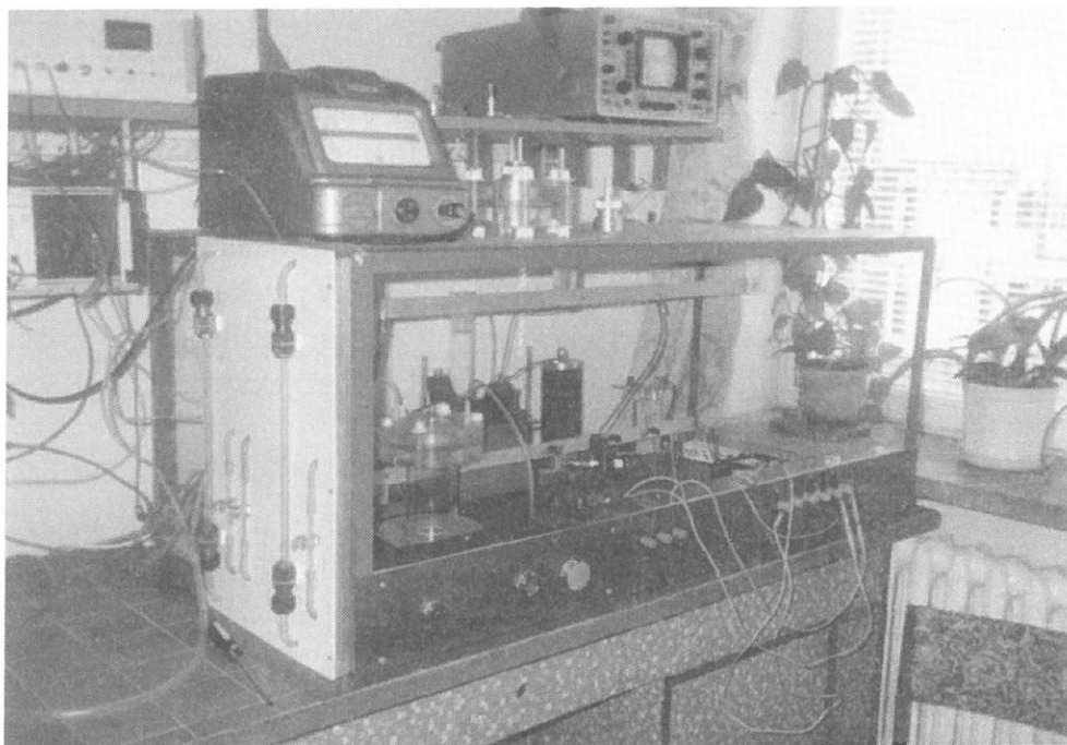
Stanowisko do badań nad plazmochemiczną syntezą ozonu.
