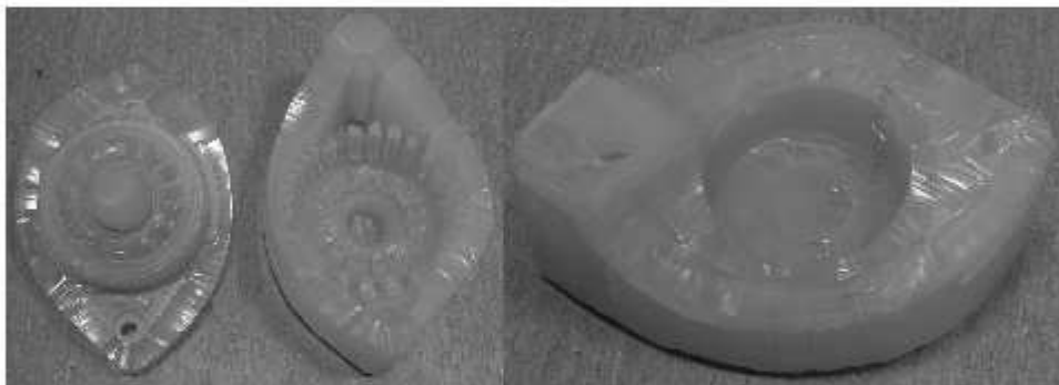
Fig 3. The ready silicone die
