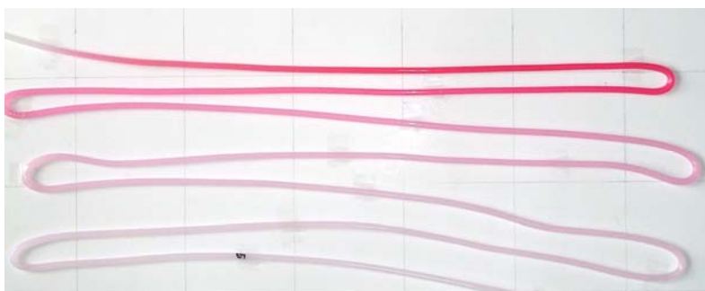
Rys. 2. Wytłoczyna otrzymana w układzie uplastyczniającym o L/D = 20 przy prędkości ślimaka 1,67 \text{ s}^{-1}
