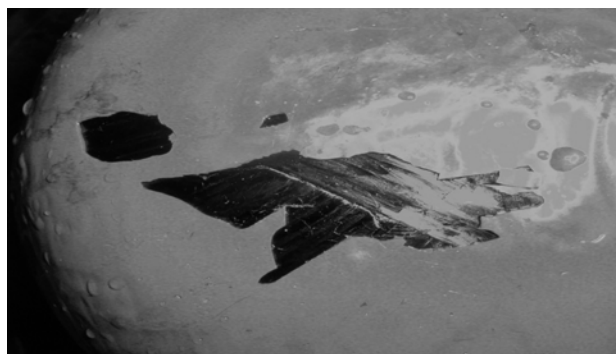
Fot. 2. Zbiornik kompozytowy z żywicy i włókna szklanego z widocznym pęknięciem
