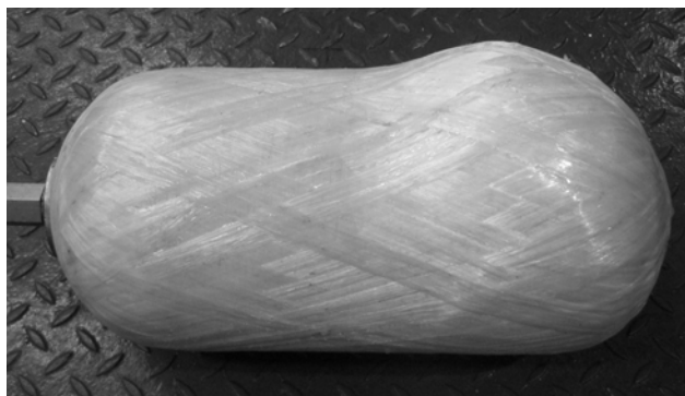
Fot. 1. Zbiornik kompozytowy z żywicy i włókna szklanego po hydraulicznym ciśnieniowym teście rozrywającym
