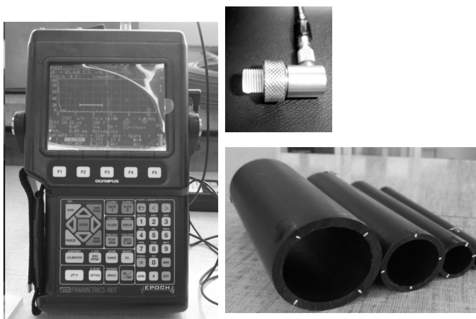
Rys. 1. Defektoskop ultradźwiękowy EPOCH 4 z głowicą pomiarową oraz kilka badanych rur o różnych średnicach
