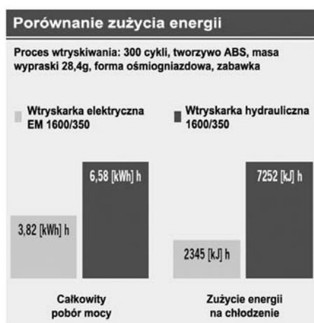
Rys. 3. Różnica w zapotrzebowaniu na energię między wtryskarką elektryczną a hydrauliczną Fig. 3. Energy requirement's difference between all-electric and hydraulic injection molding machine
