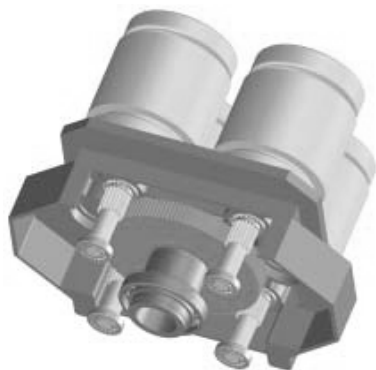
Rys. 1. Napęd kompaktowy jednostopniowy z czterokrotnym zazębieniem „i” do 12
