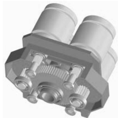
Rys. 2. Napęd kompaktowy dwustopniowy z dwukrotnym zazębieniem „i” do 45
