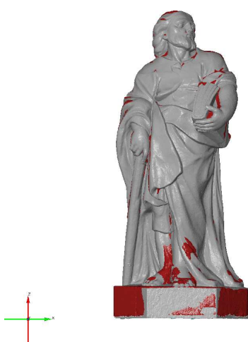
Fig. 7. Overlay of original statue (in red) and a stone replica (in gray) Ryc. 7. Powierzchnia oryginalnej rzeźby (na czerwono) i kamiennej repliki (na szaro)
