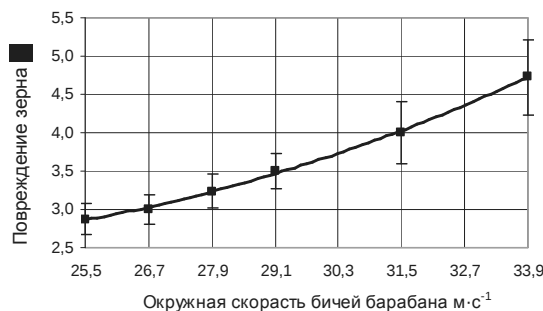
Рис. 6. Влияние окружной скорости бичей барабана комбайна New Holland CX 860 на повреждение зерна пшеницы Ширвинта: a = 10-10 мм; b = 6 мм; u = 13 мм; d = 7 мм;
