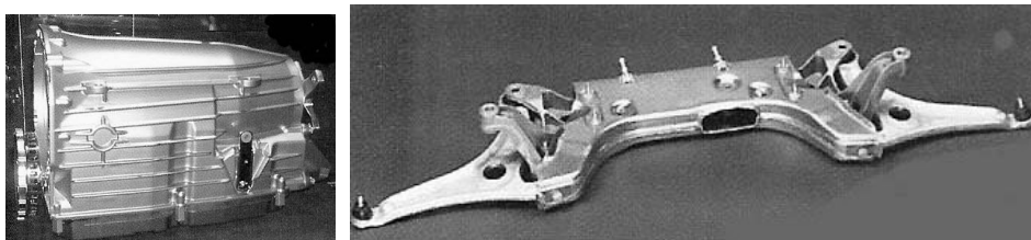
Rys. 6. Obudowa skrzyni biegów ze stopów i wspornik zawieszenia przedniego ze stopów Al Fig. 6. The casing of the gear-box made of alloys and the bracket of the front suspension of alloys Al
