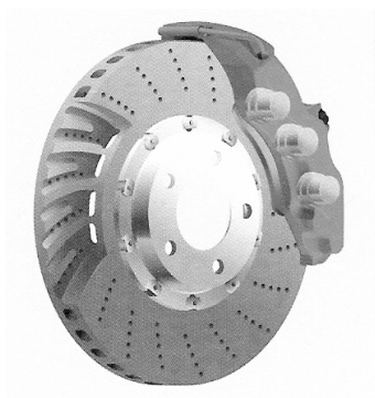
Rys. 14. Tarcza hamulcowa z materiałów ceramicznych [Mat. firm]
