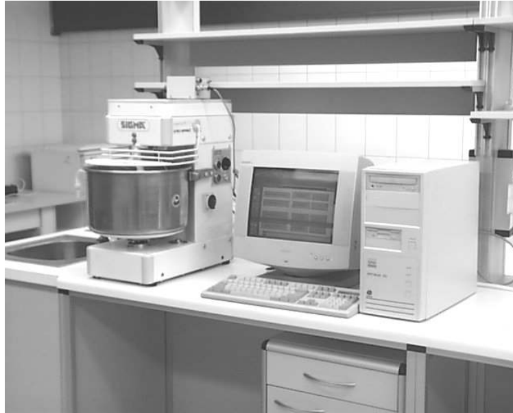
Rys. 1. Stanowisko badawcze do pomiaru procesu mieszenia: 1) miesiarka spiralna SIGMA MG12 o zmodyfikowanej konstrukcji, 2) komputer PC, 3) układ elektroniczny pomiaru momentu obrotowego i temperatury
