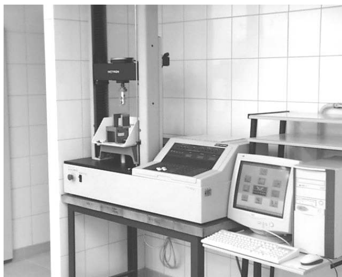
Rys. 2. Stanowisko badawcze do pomiaru tekstury (Instron 4301)
