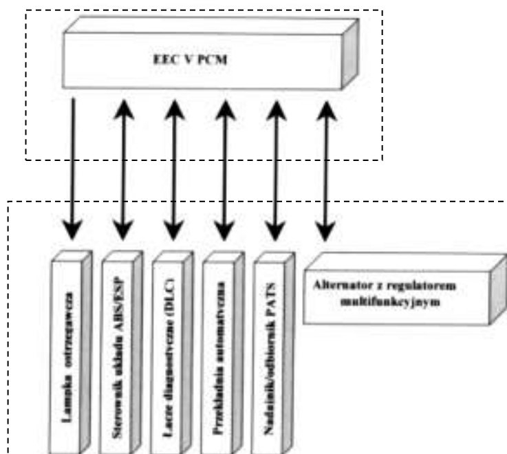
Rys. 1. Schemat funkcjonalny transmisji sygnałów wejściowych i wyjściowych czujników a PCM EEC V
