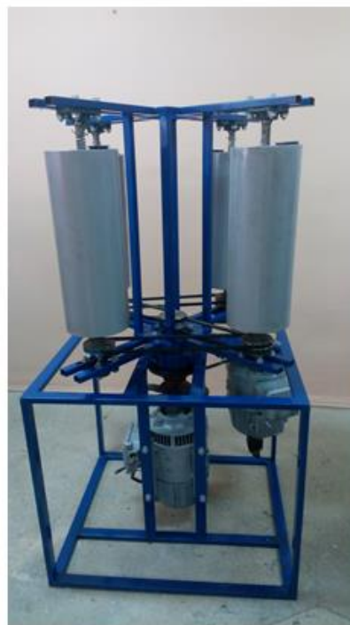
Рис. 1. Вибрационно-планетарная машина: а) принципиальная схема; б) внешний вид; 1, 12 – приводные двигатели; 2, 13 – упругие муфты; 3, 8 – клиноременная передача; 4 – ведомый шкив привода; 5 – пустотелый вал; 6 – водило; 7 – приводной вал контейнера; 9 – контейнер; 10 – упругие элементы; 11 – дебалансы; 14 – центральный вал; 15 – центральный шкив
