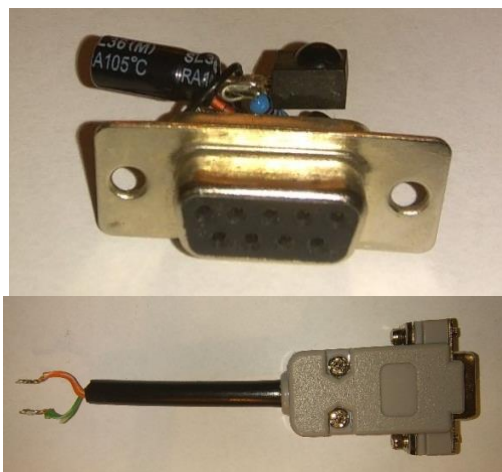
Rys. 10. Wykonany układ RS232 łączący tory pomiarowe z komputerem
