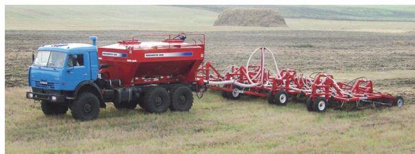
Рис. 3. Посевной комплекс «Agrator-8500 АВТО» на базе автомобиля КамАЗ.
