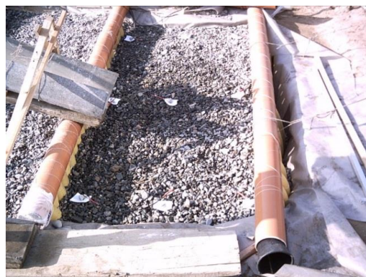
Rys. 3. Grupa czujników E (15 cm od góry złoża) w fazie stałej (kamień) i w fazie gazowej (powietrze)
