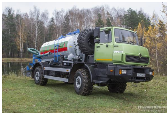
Рис. 4. Автомобильное шасси Урал-432065 с оборудованием для внутрипочвенного внесения жидких удобрений СТА-5ЖО.
