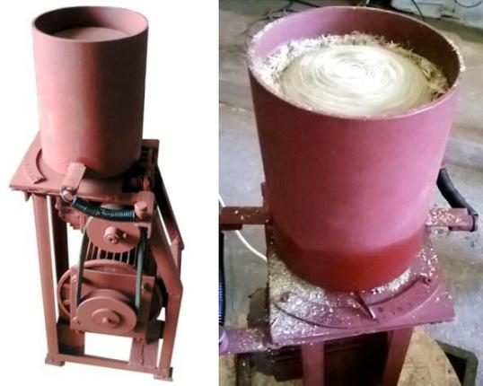
**Рис. 3.** Ротационный вискозиметр для определения вязкости кормосмеси
