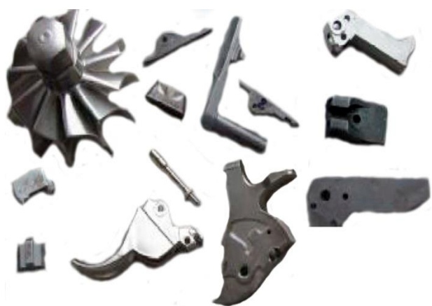
Рис. 2. Детали изготовлены с помощью МИМ-технологии
