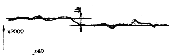
Рис. 1. Профилограмма поверхности вала Fig. 1. The depth of roughness of the shaft surface
