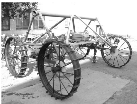
Рис. 2. Специализированное ширококолейное средство механизации сельскохозяйственного производства для колеиной системы земледелия ТГАТУ
