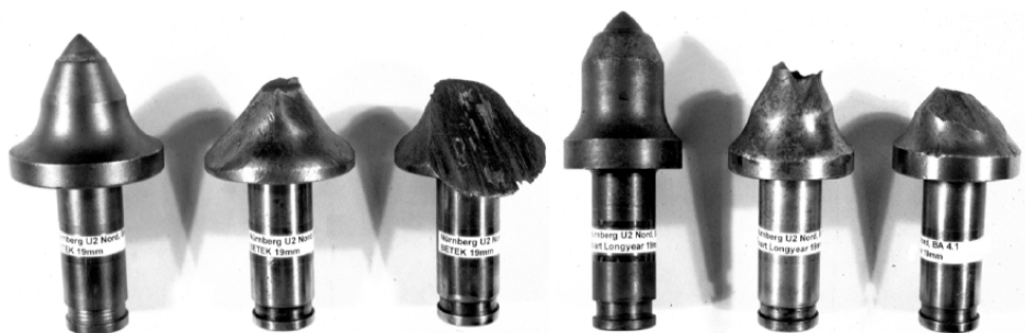
Rys. 4. Obserwowane formy zużycia noży obrotowych [12]
