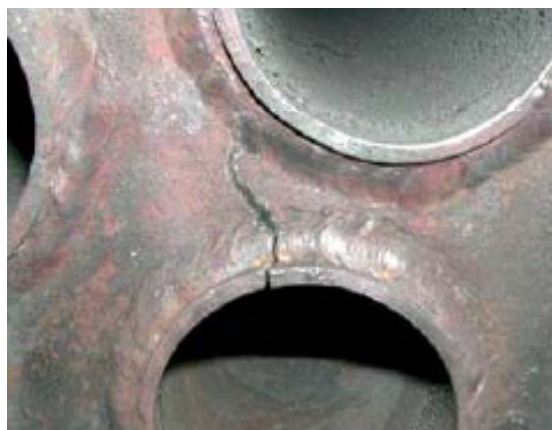
Rys. 7. Ściana sitowa kotła pęknięta pod wpływem długotrwałego przegrzania
