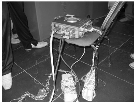
Рис.10. Переключатель датчиков ПД-100М Fig.10. Switch sensors PD-100M
