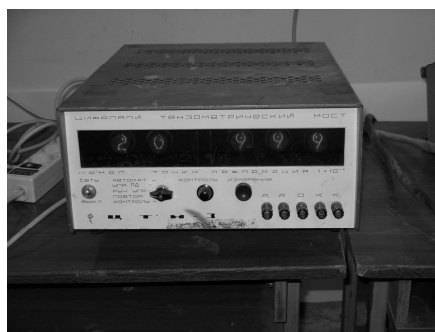
Рис.9. Мост цифровой тензометрический ЦТМ-3 Fig.9. Bridge digital strain gauge CTM-3
