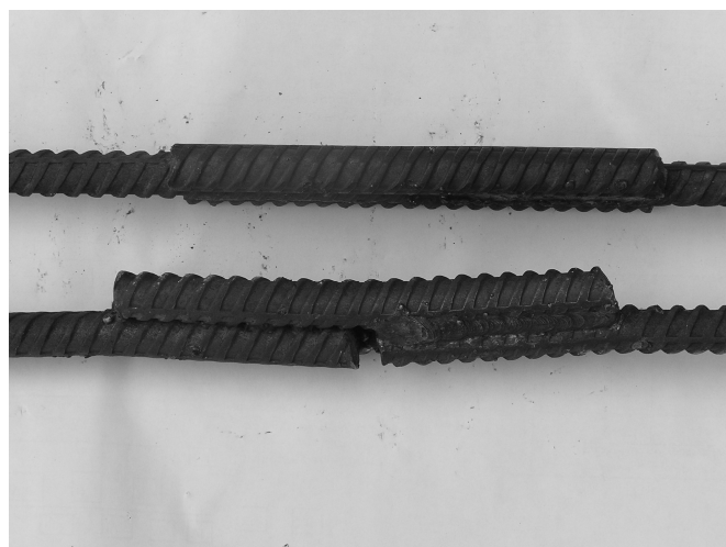
Рис. 3. Сварные стыки арматуры со смещенными боковыми накладками во внутрь колонны до и после испытания
