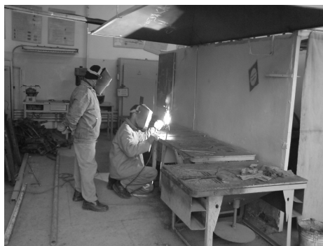
Рис.4. Сборка и прихватка сварного соединения Fig.4. Building and tacking weld
