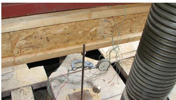
Рис.2. Испытание балок: а - общий вид испытания; б - прогибомер бРАО и тензорезисторы подключенные к тензометрическому мосту ЦТМ-3 в середине пролета балки
