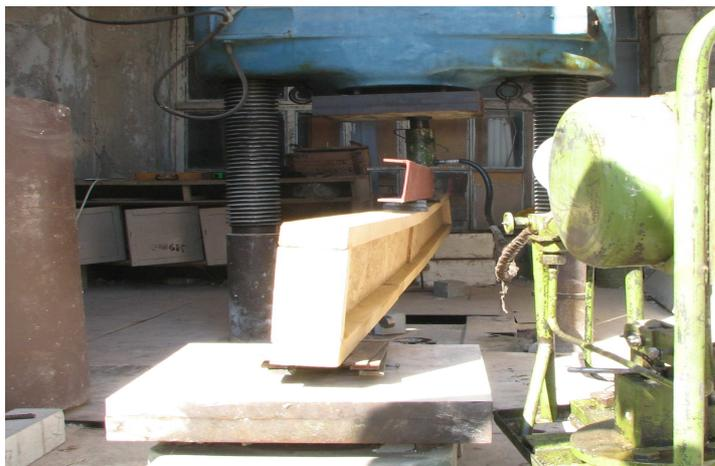
Рис.4. Изгиб балки из плоскости
