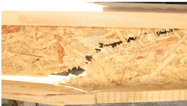
Рис.3. Характер разрушения образцов а - разрушение нижнего пояса по клеевому соединению; б - разрушение клеевого соединения стенки с поясом с последующим срезом стенки.
