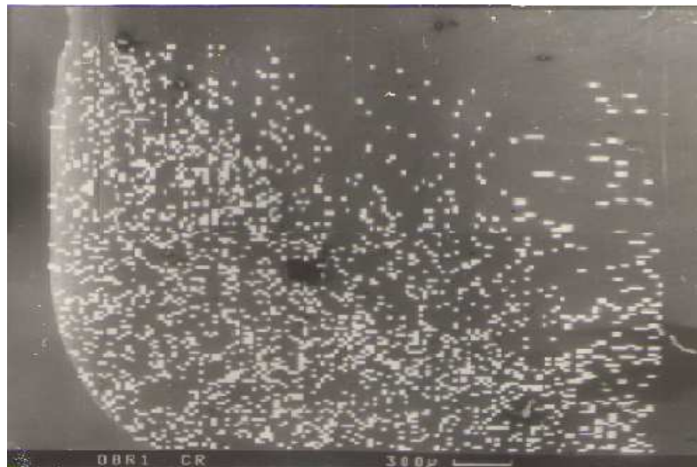
Рис.3. Глибина проникнення хрому ( \text{Cr} ) в основу молотка, x 1200
