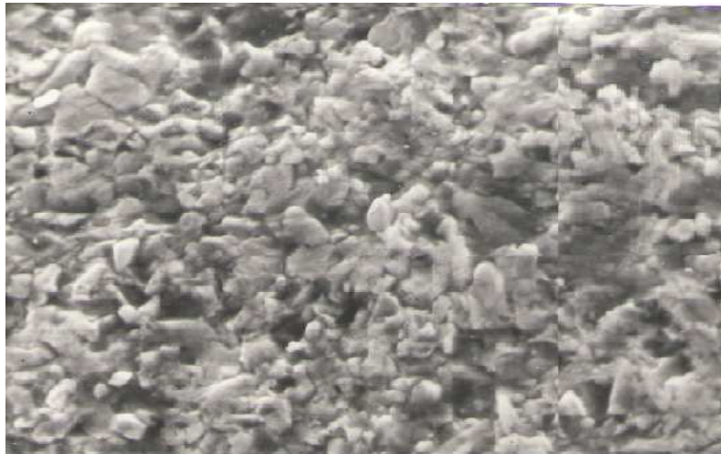
Рис. 2. Скануючи зображення ділянки найбільшого зносу поверхні тертя молотка із сплаву КХНФ15, x 1200
