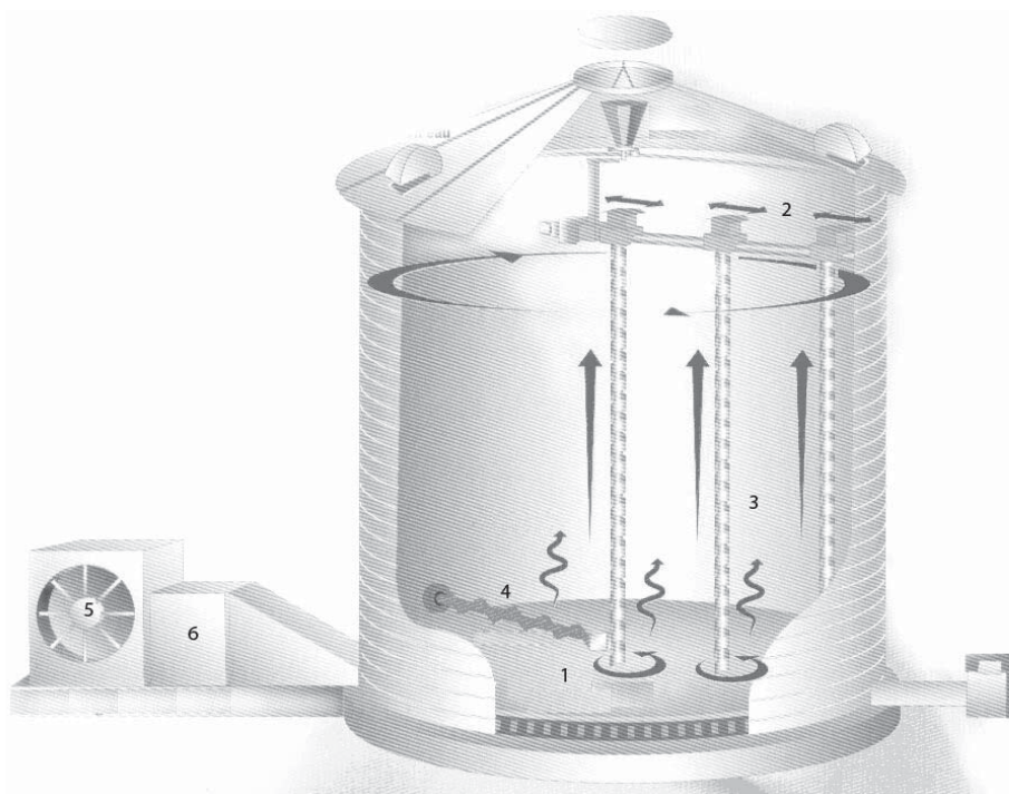
Rys. 2. Schemat technologiczny suszarni CBS CHIEF 14-6: 1 – rusztowa podłoga, 2 – przenośnik, 3 – ślimakowe mieszadło, 4 – ślimakowy przenośnik rozładowniczy, 5 – wentylator, 6 – palniki gazowe Fig. 2. Technological scheme of CBS CHIEF 14-6 grain dryer: 1 – grate floor, 2 – conveyor, 3 – auger mixer, 4 – discharge auger conveyor, 5 – fan, 6- gas burners
